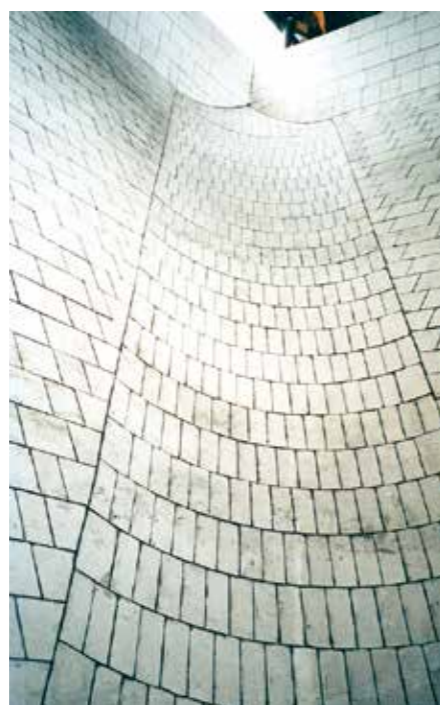
Les trémies utilisées pour l'alimentation de hauts fourneaux sont efficacement blindées en KALOCER.
