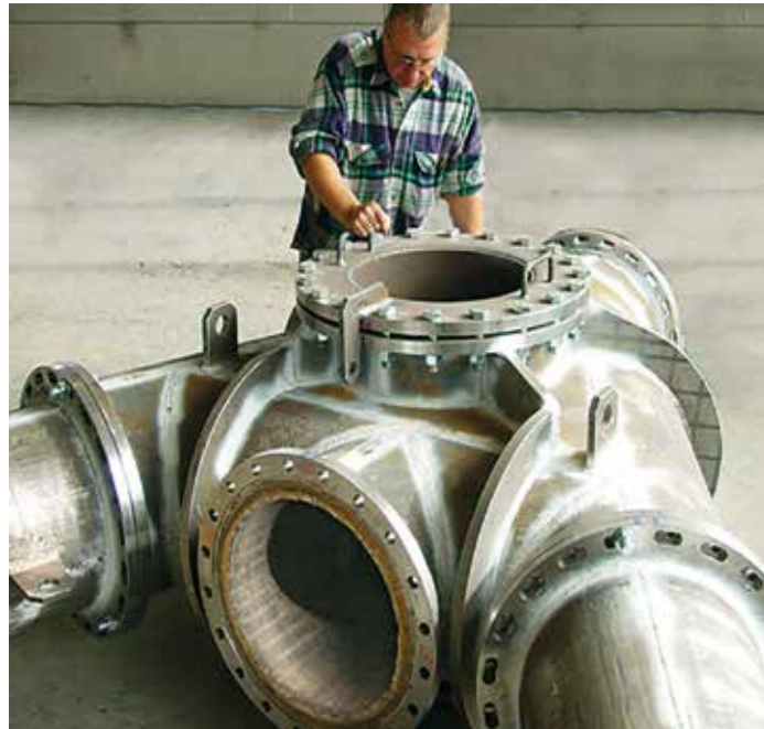
Conduite de compensation de pression de haut fourneau; structure autoportée réalisée en acier rechargé KALMETALL W100 30 + 6; diamètre 450 mm
