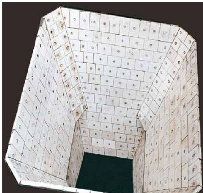
Trémie d'alimentation de haut fourneau protégée avec des plaques en KALOCER, la fixation est mécanique.
