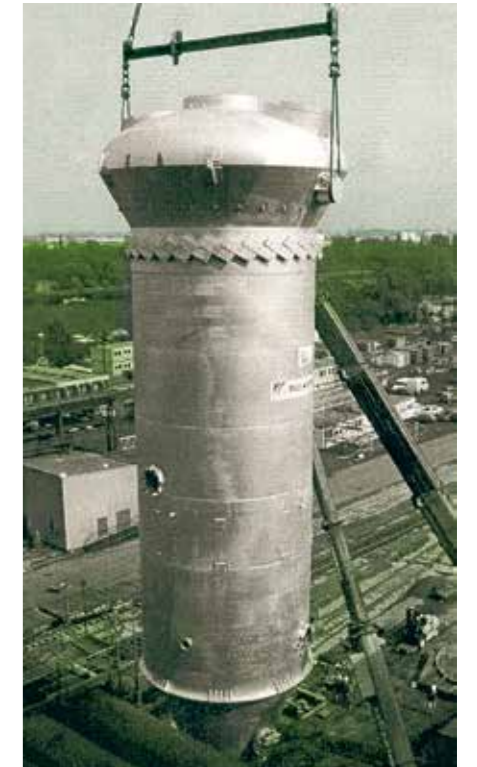
Cyclones de dépoussiérage de hauts fourneaux efficacement protégés par une combinaison optimale de matériaux.
