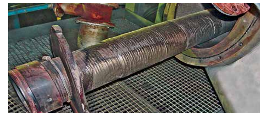
Brûleur à charbon pulvérisé équipé d'un blindage en KALMETALL.
