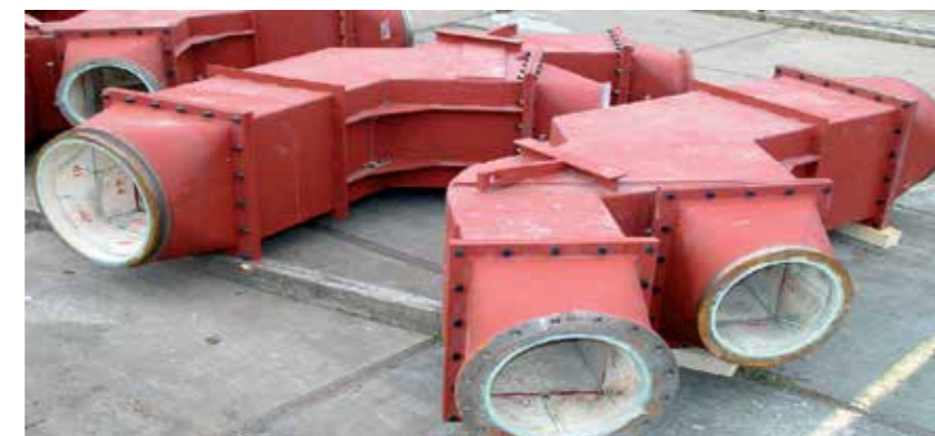
Boîtes de distribution de charbon pulvérisé protégées en KALCOR pour les revêtements à surface importante et KALOCER pour la résistance maximale à l'usure.
