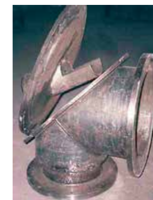
Brûleur à charbon pulvérisé réalisé en acier rechargé KALMETALL W100.
