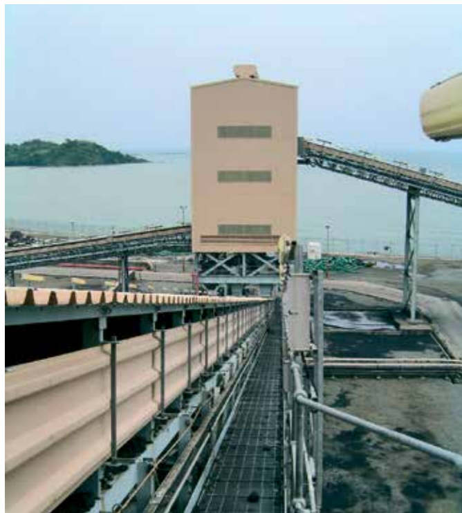
Les zones de transfert de charbon sont protégées par le basalte fondu ABRESIST ou la céramique d'alumine KALOCER (exemple Philippines).
