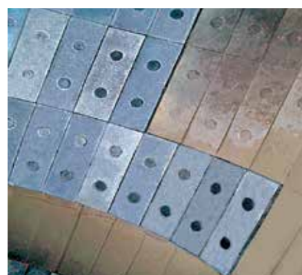
Entrée de broyeur à charbon avec KALCAST
