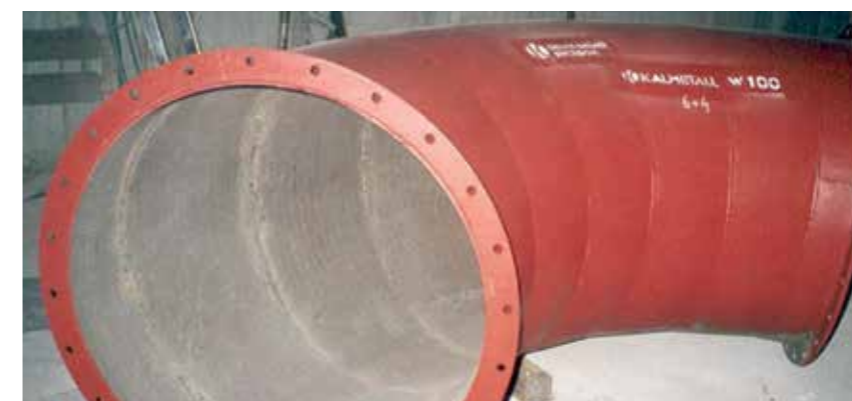
L'acier rechargé KALMETALL permet, pour les coudes à charbon pulvérisé, de confectionner des structures autoportantes sans revêtement supplémentaire.
