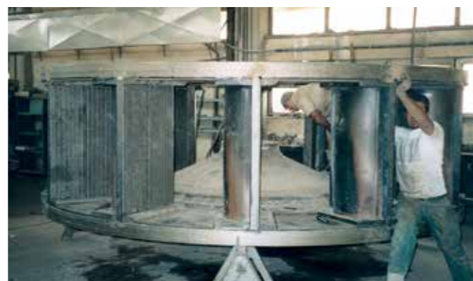
Les broyeurs à marteaux sont utilisés dans les centrales à lignite ; les plaques des cages de percussion sont blindées en KALMETALL W100.
