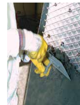
Les séparateurs sont souvent aussi protégés par des aciers rechargés KALMETALL ou des revêtements sans joints en composite dur KALCRET (photos).
