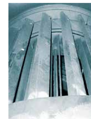
Conception à poids réduit d'une cage de séparateur en céramique de carbure de silicium KALSICA A ; des alternatives consistent dans l'emploi de KALMETALL et de mosaïques KALOCER.
