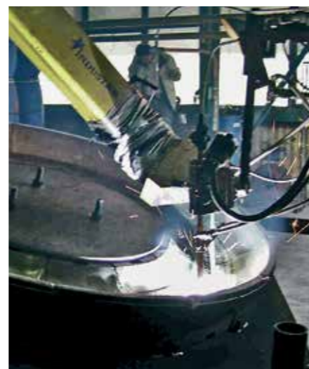
Régénération d'une table de broyage en KALMETALL W100.
