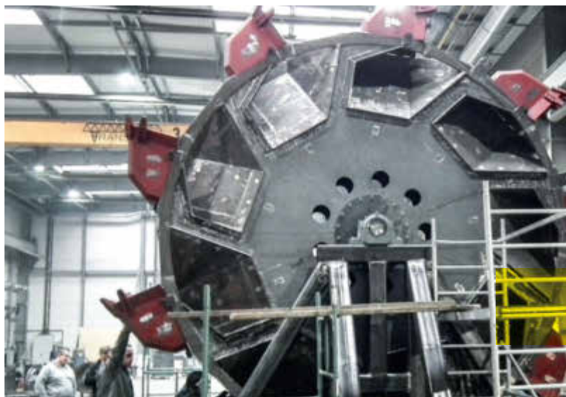
Une roue-pelle, construction soudée en KALMETALL réalisée sur mesure.
