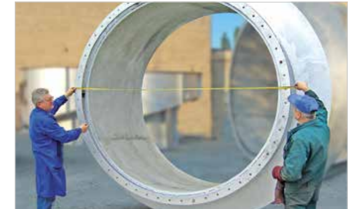
Revêtement d'un séparateur de broyeur à ciment réalisé en KALCRET ; grand diamètre du séparateur : 3 200 mm
