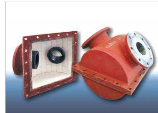
Boîte de déviation Kalenborn garnie d'ABRESIST et de KALOCER, les éléments particulièrement sollicités sont interchangeables
