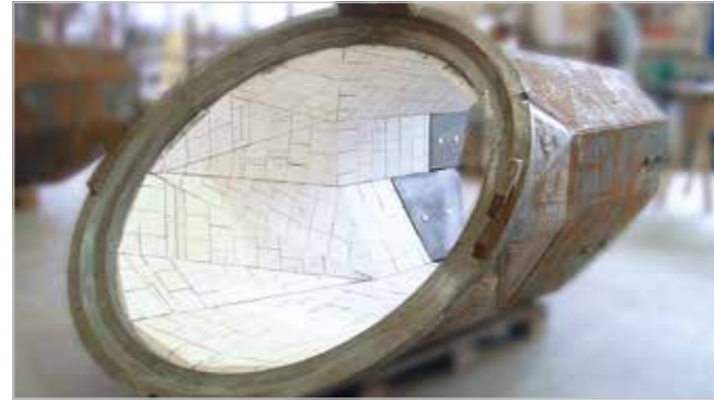
Trémie octogonale sidérurgique ; les plaques de KALOCER de 50 mm d'épaisseur sont à coupe tridimensionnelle
