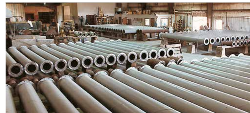
Tuyaux de transport hydraulique de cendres en cours de fabrication à l'usine de Kalenborn Abresist dans l'Indiana, aux États-Unis
