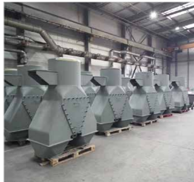
Répartiteurs de charbon pulvérisé en KALMETALL
