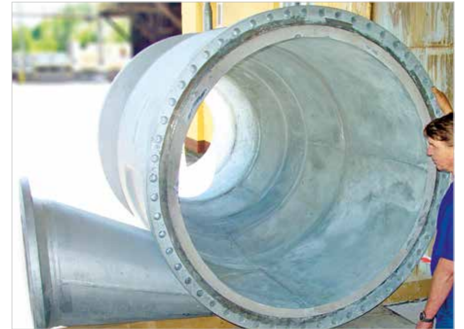
Cyclone d'un diamètre de 1 200 mm, garni en KALSICA, fonctionnant en continu : du sable siliceux atteignant 300 °C est extrait par cet appareil
