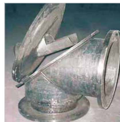
Brûleur à charbon pulvérisé protégé de KALMETALL
