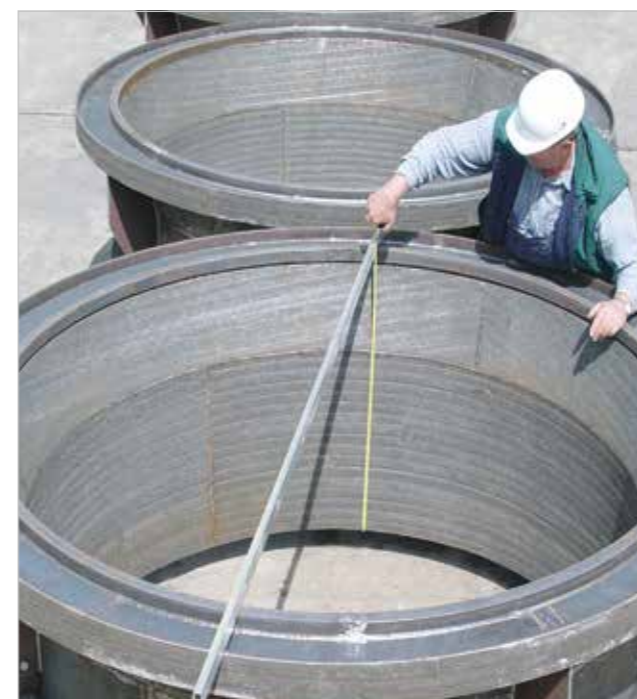
Cônes de séparateurs de ciment réalisés en KALMETALL à structure autoportante
