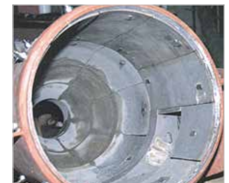
Protection en KALCAST d'un cyclone équipant une installation de décontamination des sols
