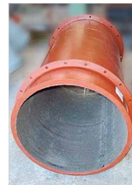
Tuyauterie en KALMETALL équipant un système de dépoussiérage, diamètre intérieur 400 mm, épaisseur 8 + 5 mm
