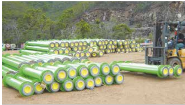
Tuyaux équipés de KALOCER de haute résistance à l'usure pour le transport de boue de minerais dans une mine
