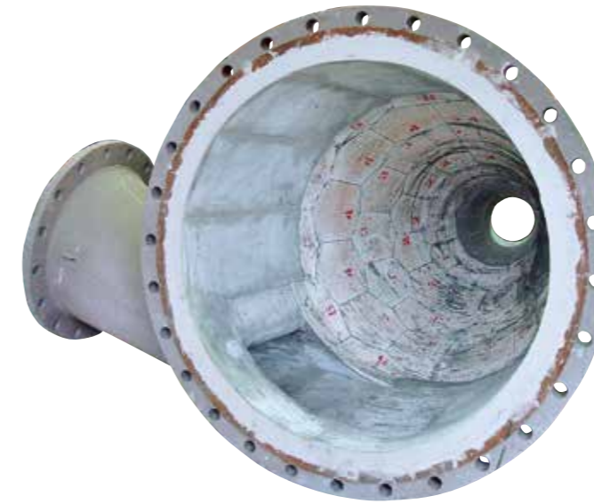
Protection efficace d'un cyclone de traitement de sable de silicium réalisée en céramique de corindon de zirconium KALCOR et en céramique de carbure de silicium KALSICA
