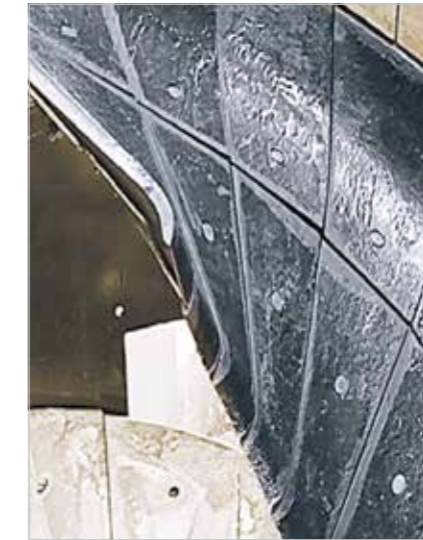
Descenseur hélicoïdal de puits de mine de charbon équipé d'une protection performante en KALCAST
