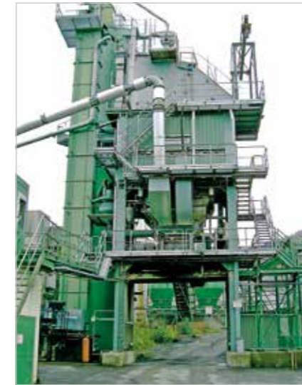
Malaxeur d'enrobé, soumis à une usure importante, protégé par un revêtement en KALCAST
