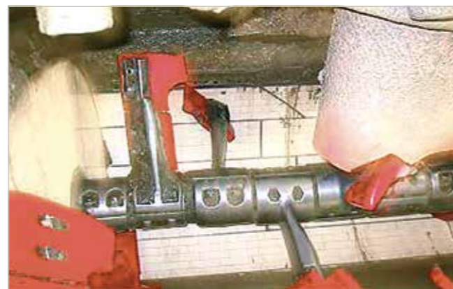
Revêtement en céramique d'alumine KALOCER dans un malaxeur à béton, les palettes de malaxage sont en matériau synthétique KALEN PU
