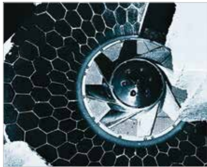
Comme dans un mélangeur géant, les balles de vieux papier sont malaxées dans des déchiqueteurs pour la régénération du papier. En raison des pollutions importantes, le fond est protégé efficacement avec de l'ABRESIST
