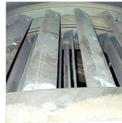
Aubes directrices de séparateur réalisées en KALSICA A équipant un broyeur à charbon
