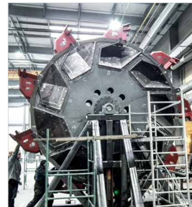
Roue pelle réalisée en KALMETALL pour une usine sidérurgique Nord-Africaine.
