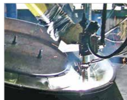
Rénovation d'une table de broyage par le service rechargement
