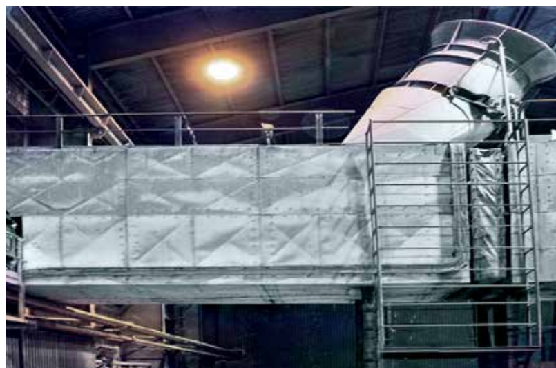
Protection des lignes de farine crue contre l'usure par abrasion avec le composé dur KALCRET, épaisseur du revêtement 25 - 40 mm, température d'utilisation 200 °C
