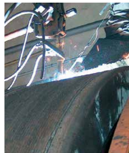
Service Kalenborn : régénération d'un galet de broyeur en KALMETALL W100
