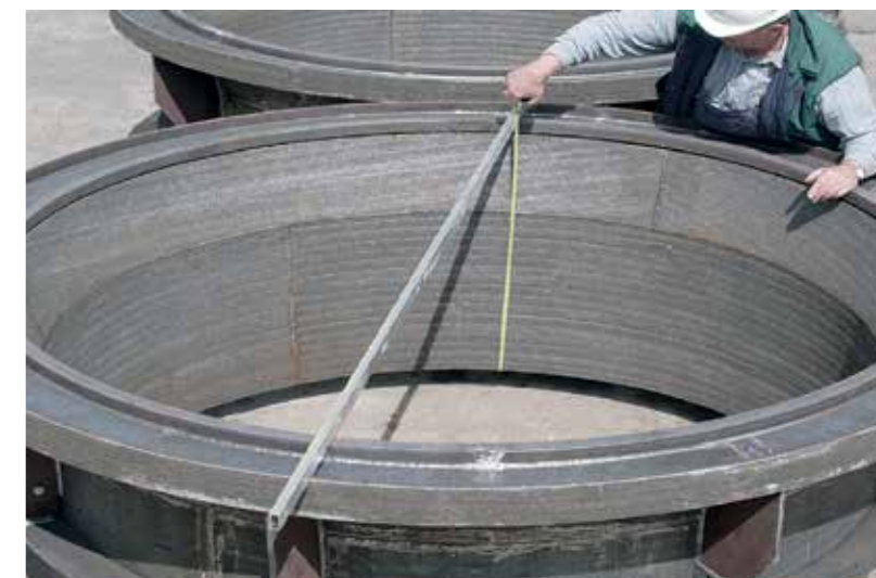
Cônes de séparateurs à ciment en KALMETALL W100, 6 + 4, diamètre 3000 mm
