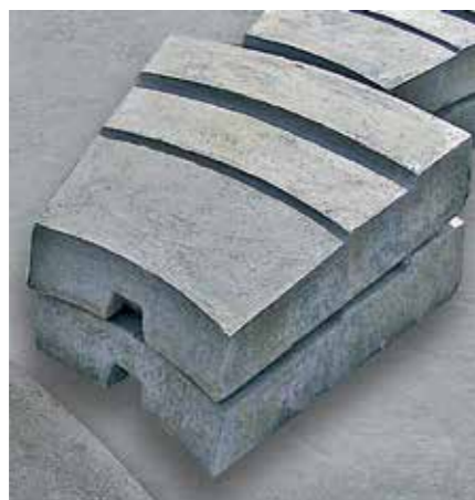
Segments d'une table de broyage d'un diamètre de 5000 mm équipant un broyeur vertical à galets, les éléments de dimension inférieure sont moulés en une seule pièce.
