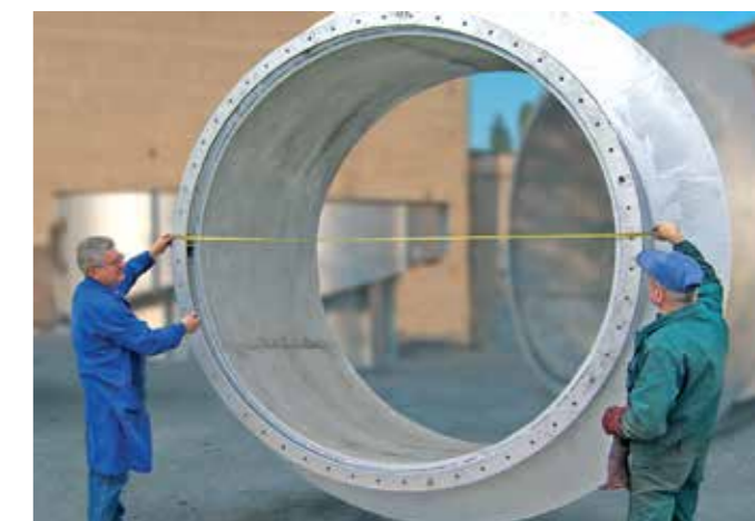
Revêtement d'une partie de tuyau dans le broyage de ciment avec du KALCRET BNX.
