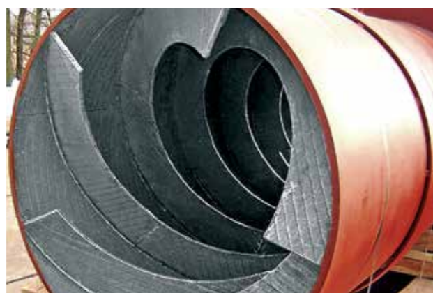
Revêtement de gaines de transport de fumées de refroidisseur réalisé en composite dur KALCRET BNY
