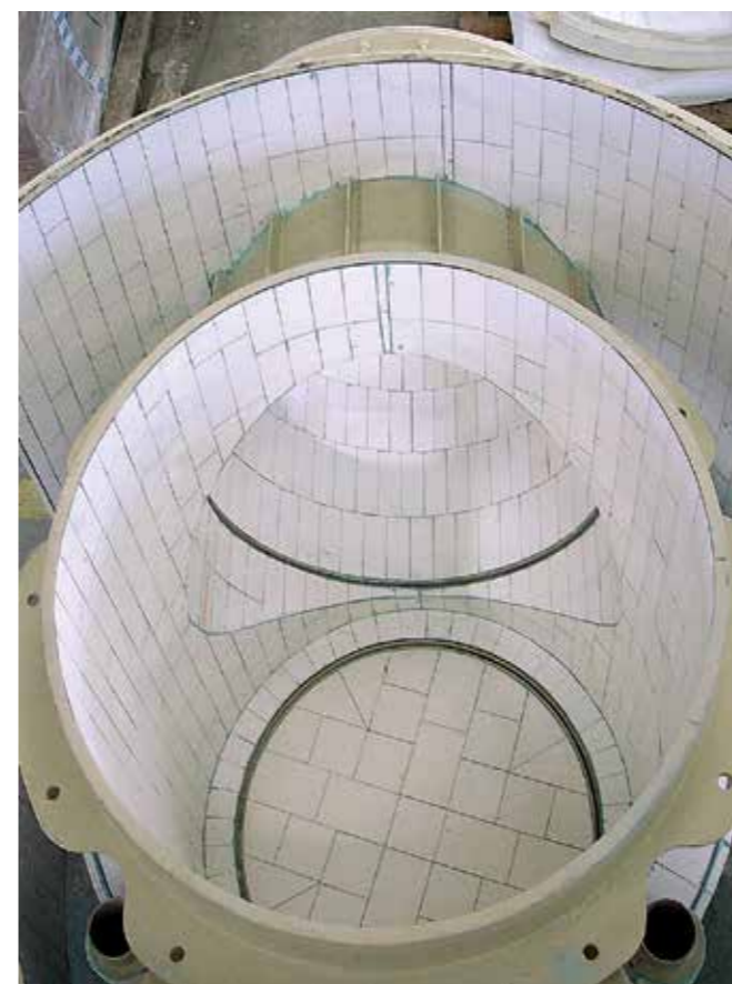
Le basalte fondu ABRESIST est un matériau de protection éprouvé pour séparateurs dans l'industrie du ciment.
