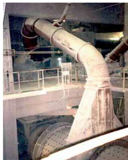
Revêtement en basalte fondu ABRESIST de la conduite de décharge d'un broyeur à boulets
